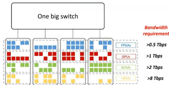
图 2-10 非聚合数据中心（Disaggregated DC）的互连带宽要求 [7]
