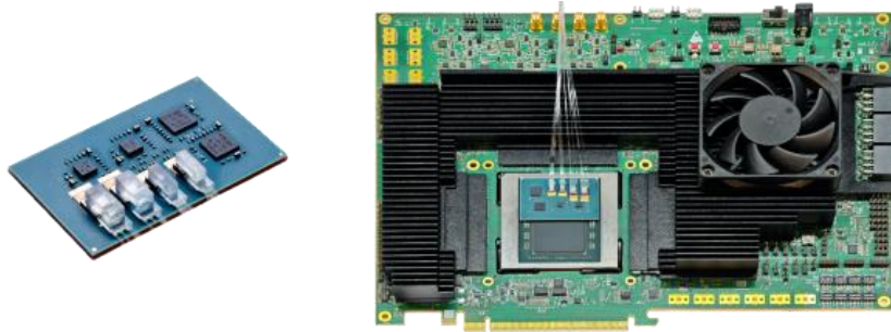
图 3-8 xPU-CPU光电共封芯片组件（左）及原型系统（右）
